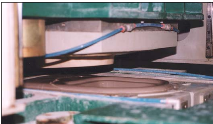
Sequenza di incollaggio automatico della brida
