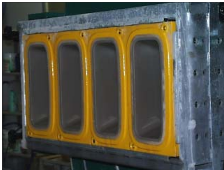
Stampo in resina a 4 cavità per cassette a spessore obbligato installato su HPC-201/170 Resin mould with 4 cavities for solid cast WC-Tank installed on HPC-201/170
